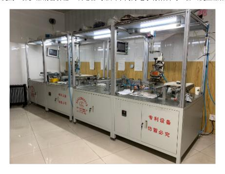
将热保护器置于无搅拌空气中,其环境温度保持在25℃±2℃以内,并通以额定脱扣电流,测量热保护器从接通到脱扣的时间(不少于三个点),应符合额定脱扣电流的规定。用微欧计测量两引出线或端子间的接触电阻,在有异议的情况下可去除产品导线和端子,应符合接触电阻的规定。绝缘电阻试验,将热保护器置于额定断开温度上限温度10K的环境温度下,待其触头分断后,用500V兆欧表检测热保护器下述部位间的绝缘电阻,应符合绝缘电阻的规定。引出线或端子间;引出线或端子与外壳绝缘层表面间。佛山变压器热保护器成都KW热保护器厂家哪家好,选择常州市同力电子有限公司。
